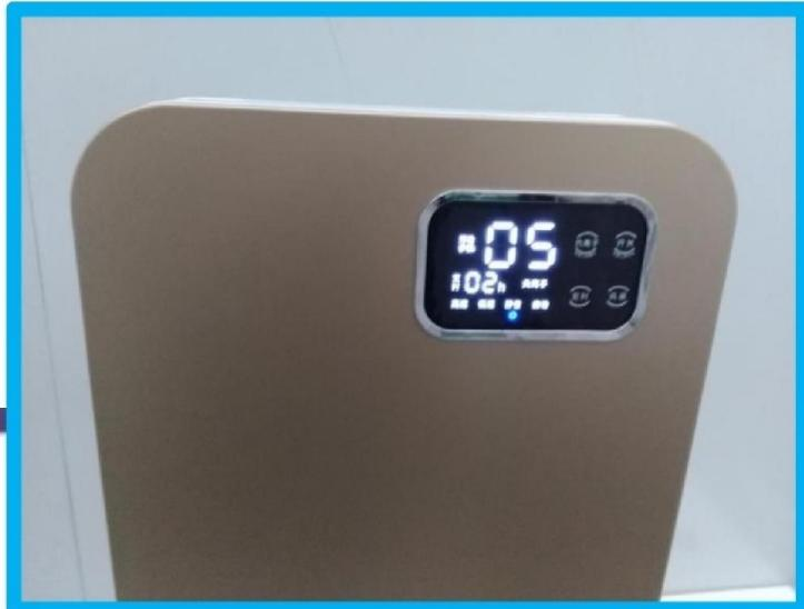
開機時汙染參數顯示有誤差,需要2分鐘的預熱時間,之後開始顯示實際的參數
